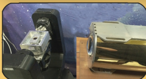
تصویر شبیه ساز خورشید و میز سه درجه جهت آزمایش دقت حسگر خورشیدی
